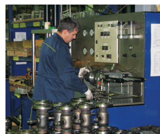
Тестирование шаровых кранов
